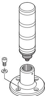
Mit Hilfe des Montageflansches SBT-MF-M30 wird die Signalsäule SBT-x einfach und schnell montiert. Der Montageflansch selbst kann mit 4 M5 Schrauben auf jeder ebenen Fläche befestigt werden. Im Anschluss muss die Signalsäule SBT-x nur noch in das vorhandene M30 Gewinde eingeschraubt werden.
