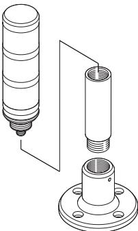
Das Verlängerungsrohr SBT-VR-100-M30 bietet die Möglichkeit einer variablen Befestigungshöhe der Signalsäule SBT-x. Eine erhabene Montageposition erhöht die Sichtbarkeit der Signalsäule aus größerer Entfernung. Durch einfaches ineinander schrauben mehrerer Verlängerungsrohre ist eine kaskadierbare Erhöhung möglich.
